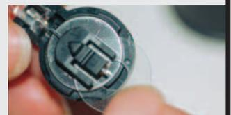
Petit disque en plastique entre l'interrupteur et les piles
